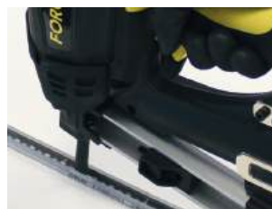
Boca estrecha para el clavado de perfiles
