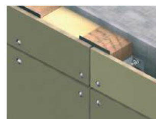
Fibrocemento sobre madera.
